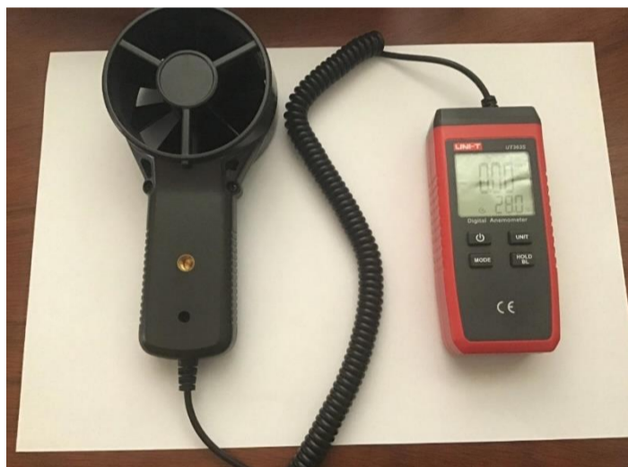
El anemómetro usado en este documento es Uni-T Digital Anemometer UT363S de Uni-Trend technology (China)
